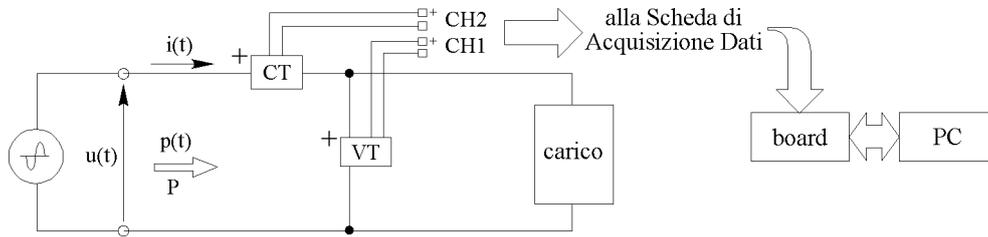
Fig.4.2 - Schema per un wattmetro digitale.
