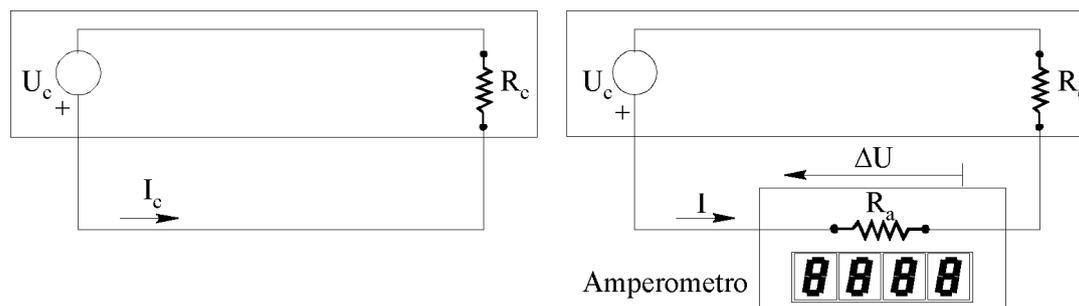
**Fig.2.2 - Inserzione di un amperometro.**
