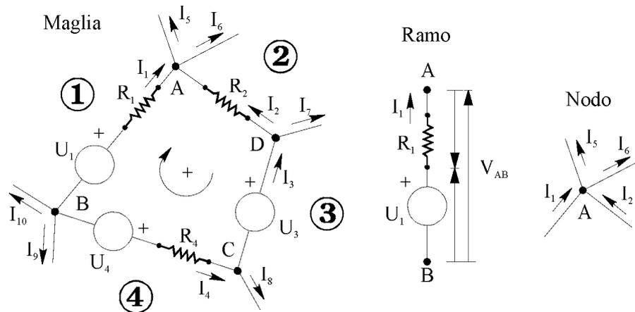
**Fig.1.2** - Rete elettrica generica con nodi e rami.
