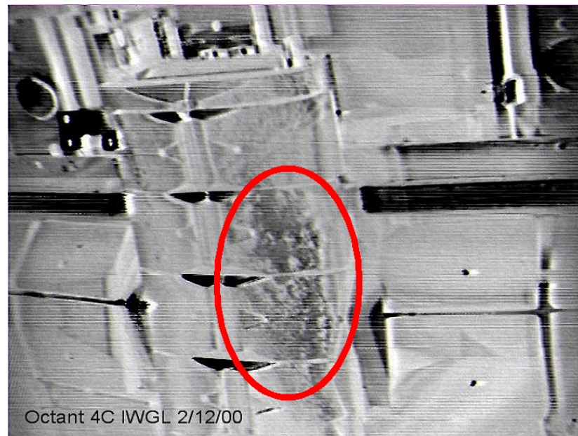
Figura 1.6: Danni prodotti da una disruzione all'interno del TOKAMAK
